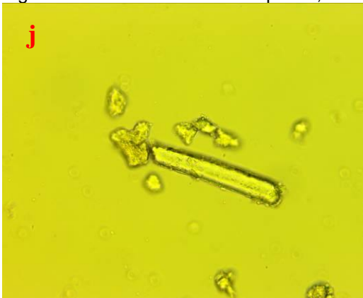
Figura 31 - Cristais da amostra pH 10,00 relação molar 1,4:1 de MgO para P-PO_4^{3-} .(j), (l).
