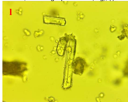
Figura 31 - Cristais da amostra pH 10,00 relação molar 1,4:1 de MgO para P-PO_4^{3-} .(j), (l).
