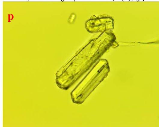
Figura 33 - Cristais da amostra pH 11,00 relação molar 1,4:1 de MgO para P-PO_4^{3-} .(o), (p).
