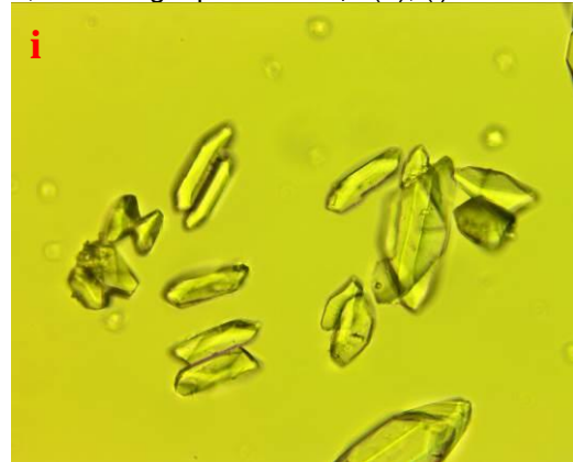
Figura 30 - Cristais da amostra 90°C relação molar 1,4:1 de MgO para P-PO_4^{3-} .(h), (i)
