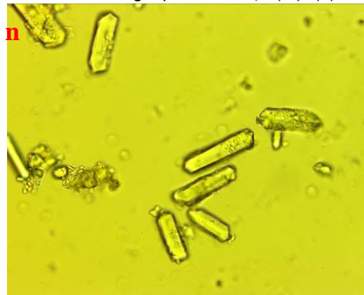
Figura 32 - Cristais da amostra pH 11,00 relação molar 1:1 de MgO para P-PO_4^{3-} .(m), (n).
