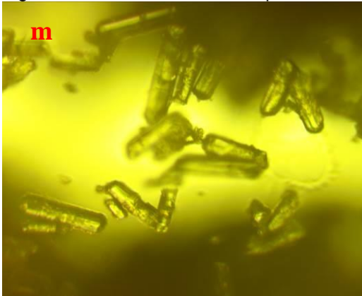
Figura 32 - Cristais da amostra pH 11,00 relação molar 1:1 de MgO para P-PO_4^{3-} .(m), (n).
