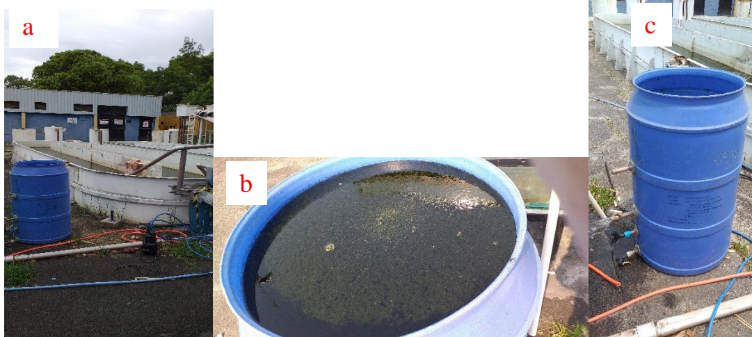
Figura 11 - (a) Bombona 200L, (b) dosagem de Tanfloc® SL e (c) drenagem do sobrenadante.
