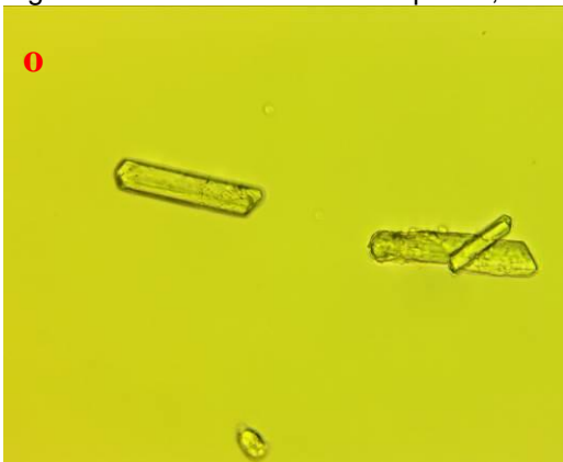
Figura 33 - Cristais da amostra pH 11,00 relação molar 1,4:1 de MgO para P-PO_4^{3-} .(o), (p).
