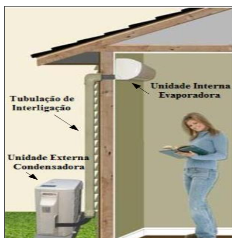
Figura 7 – Componentes do aparelho tipo split instalados numa residência (térreo)
