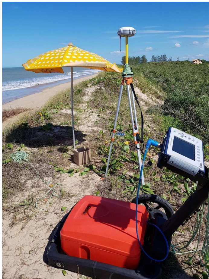
Figura 90. Equipamentos utilizados para levantamento RTK e GPR na área de estudo. Fonte: Foto da autora.
