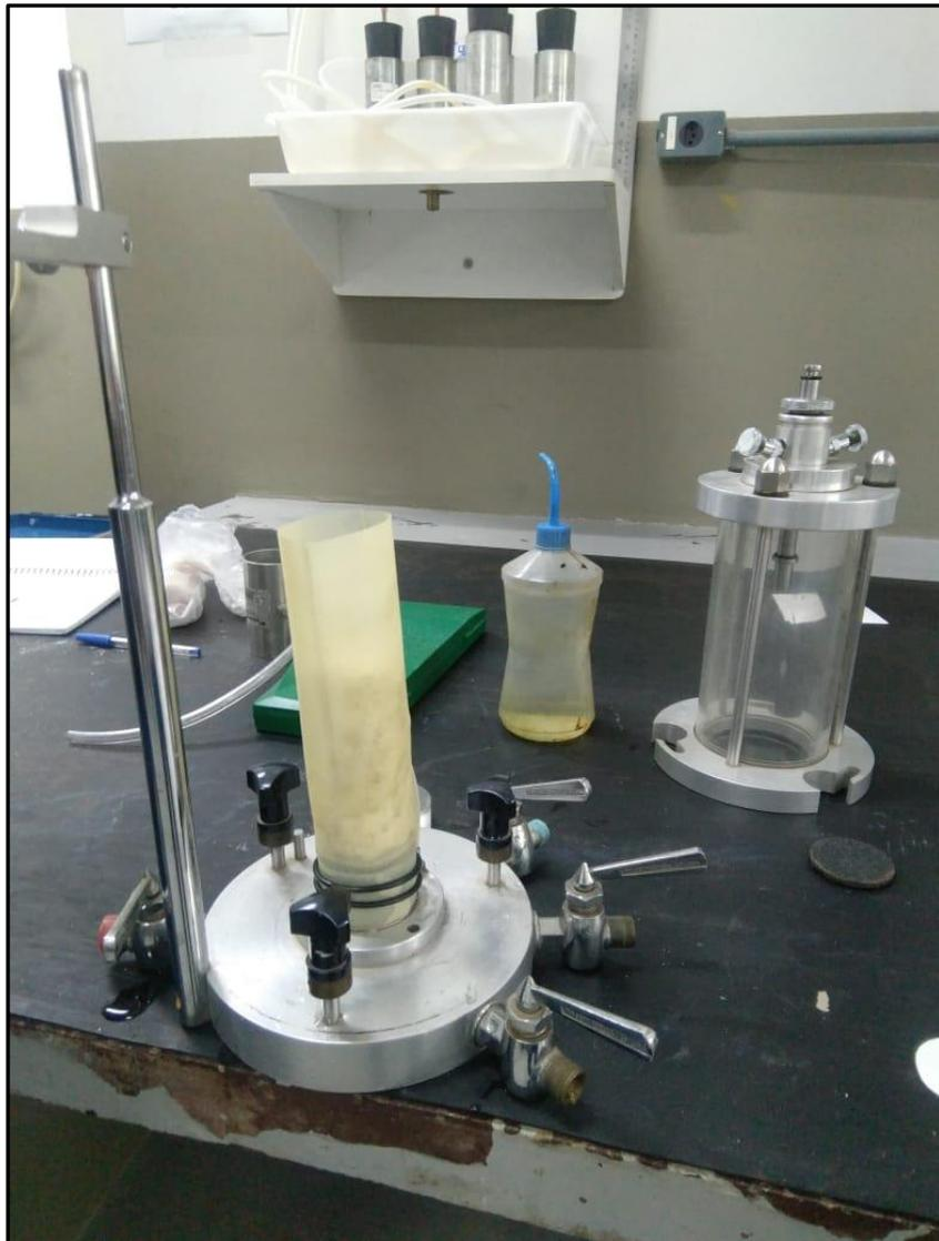
Figura 39. Corpo de prova colocado na base da cápsula triaxial. Fonte: Autor.
