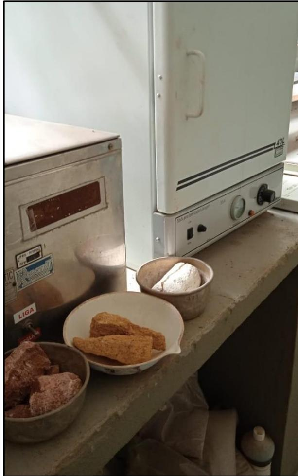
Figura 45. Amostras retiradas após secagem completa na estufa, para posterior pesagem da massa. Fonte: Autor
