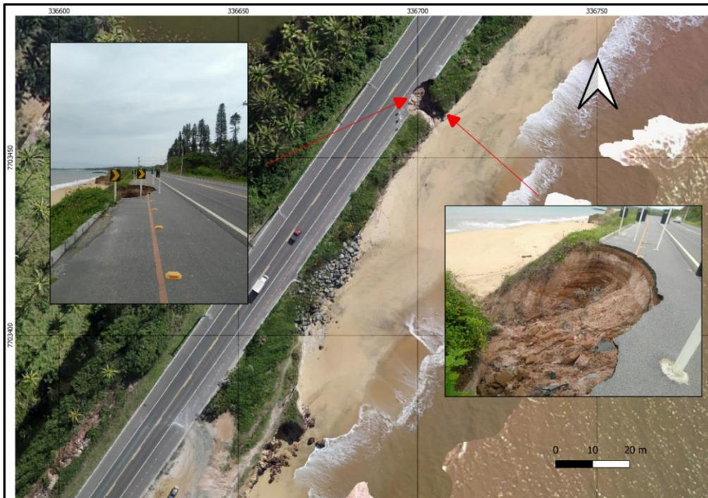
Figura 34. Destruição de parte da estrada ES-060, evidenciando uma estrutura de ruptura circular. Fonte: Autor.
