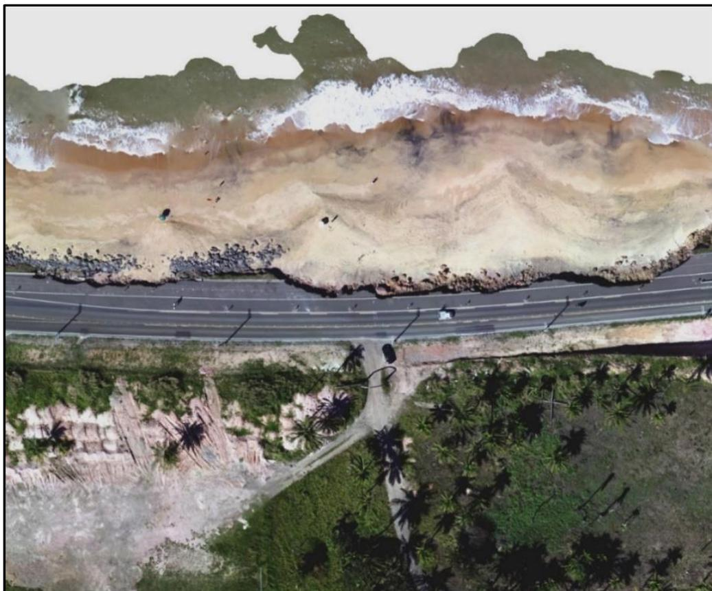
Figura 2. Parte da estrada ES-060 destruída pela ação das ondas na praia de Maimbá, com banhistas utilizando a curta faixa de praia. Erosão que necessita recuperação, causando problemas econômicos Fonte: Autor.
