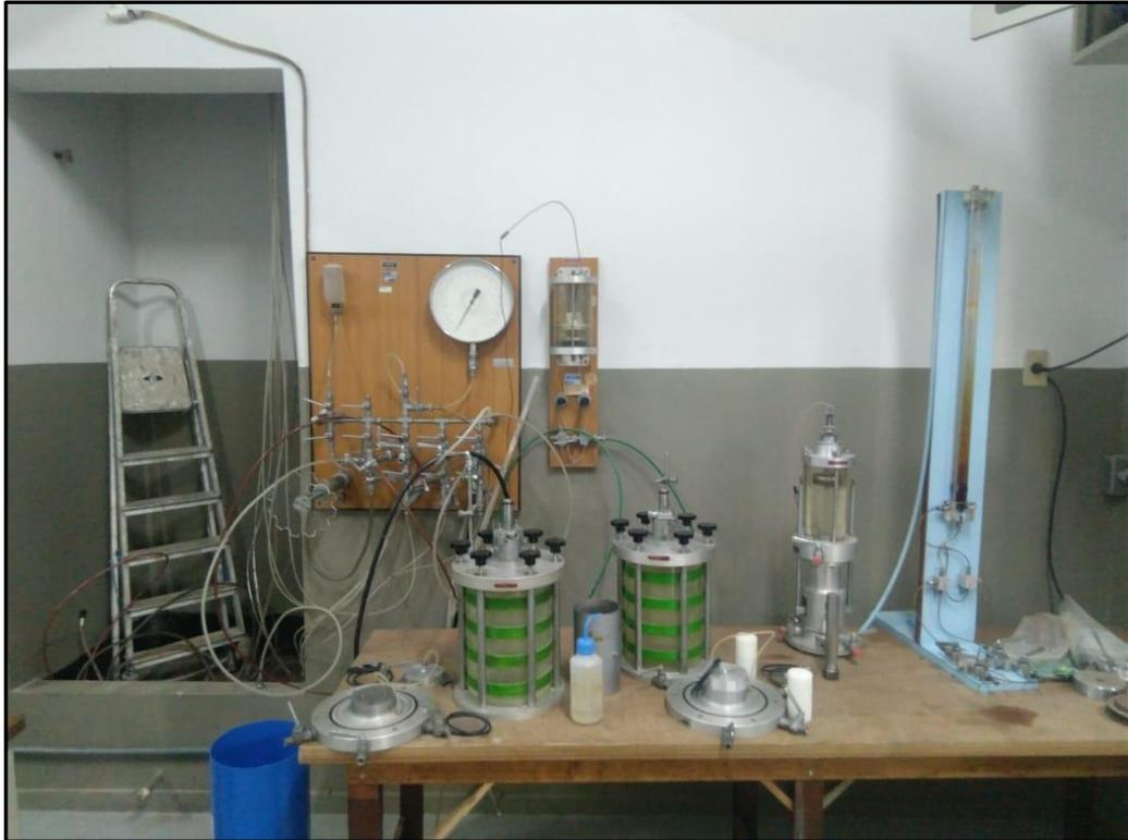
Figura 43. Permeômetro de Parede Flexível, com a cápsula triaxial ao lado direito da foto. Fonte: Autor.
