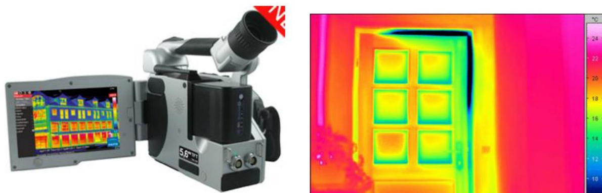
Figura 4 – Câmera termográfica (imagem da esquerda) e termograma (imagem direita)
