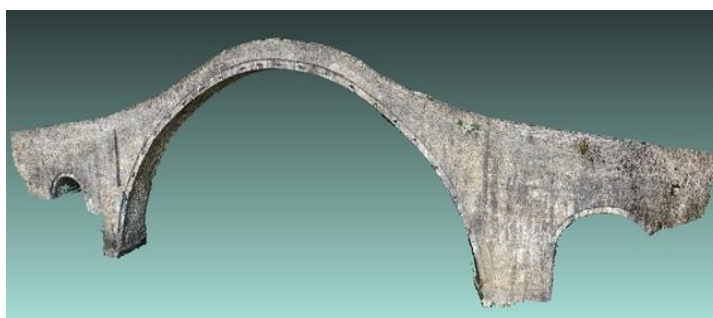
Figura 17 – Nuvem de pontos apresentando a reconstrução 3D da ponte Plaka, Grécia
