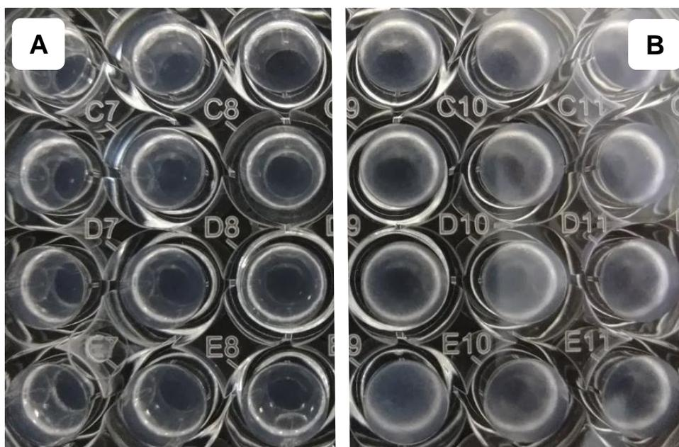
Figura 7. Placa de 96 poços recobertos com 50µL/poço de: a) gel de agarose na concentração 1,0% (m/v) e b) gel de agarose na concentração 1,5% (m/v).
