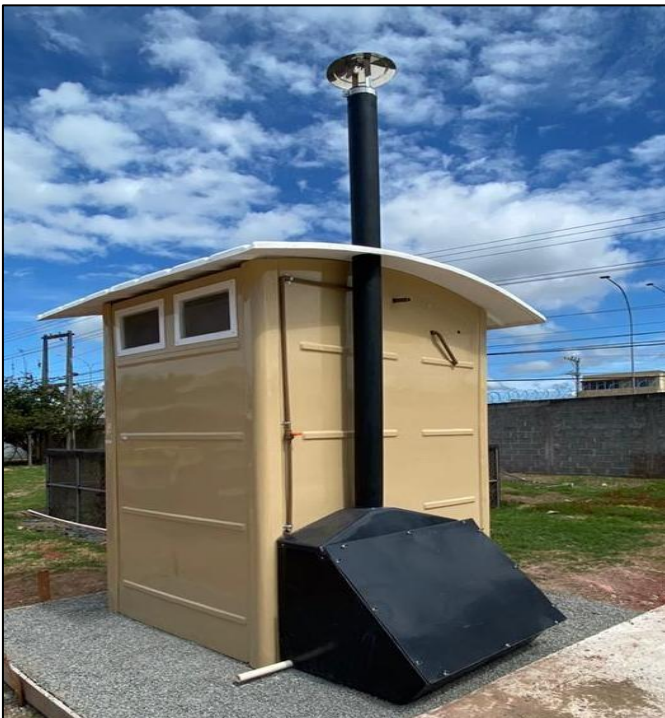
Figura 18: Banheiro seco utilizado nos testes com vistas na câmara de secagem das fezes e tubo de exaustão do protótipo
