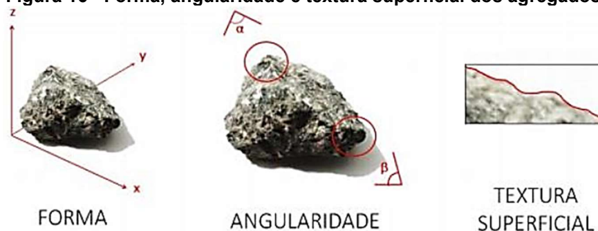
Figura 16 - Forma, angularidade e textura superficial dos agregados
