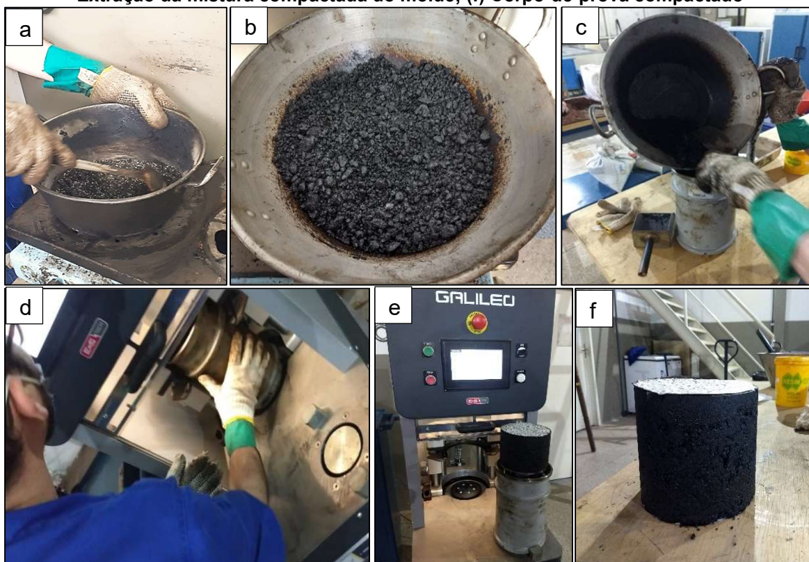
Figura 20 - Procedimento de mistura e compactação dos CPs de MAC (a) Mistura dos materiais a quente; (b) Mistura solta aquecida indo à estufa por 2 horas; (c) Mistura solta adicionada no molde; (d) Molde + mistura inserida no compactador giratório; (e) Extração da mistura compactada do molde; (f) Corpo-de-prova compactado
