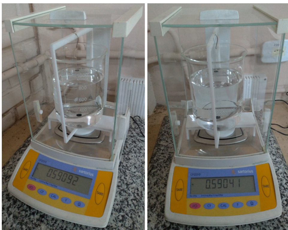
Figura 33 – Aparato montado para medição da massa suspensa para determinação da densidade. Fonte: autor.
