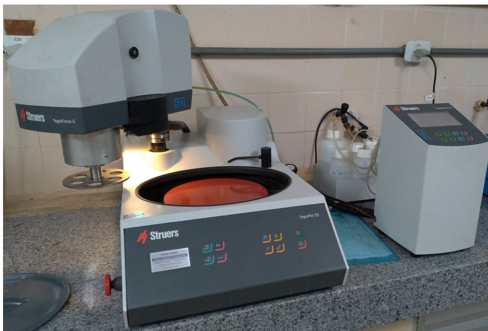
Figura 34 – Politriz Struers Tegrapol-25 combinado com TegraForce-5 para polimento das cerâmicas com finalidade de obter uma melhor superfície para o teste de dureza. Fonte: autor.
