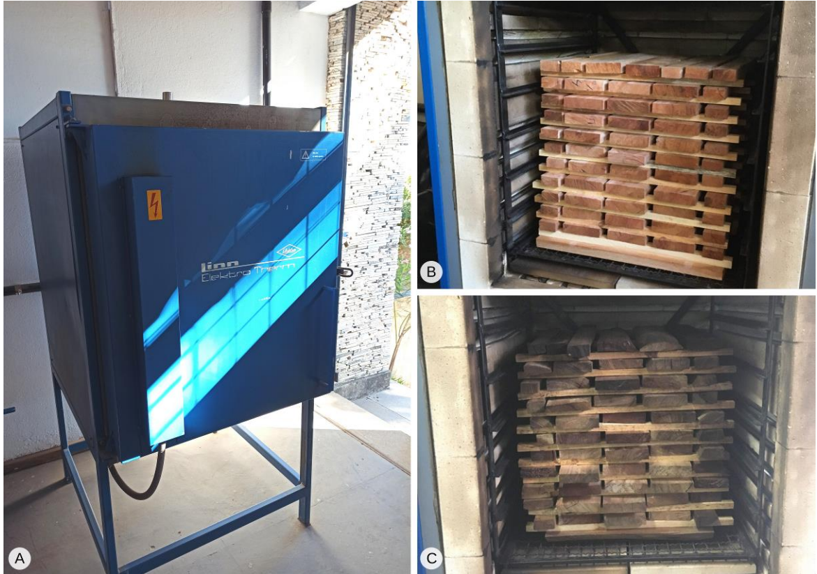
Figura 5 - Forno elétrico em que foram realizados os tratamentos térmicos. Vista frontal do equipamento (A); disposição das amostras no interior do forno antes do tratamento térmico (B); amostras no interior do forno após o tratamento (C).
