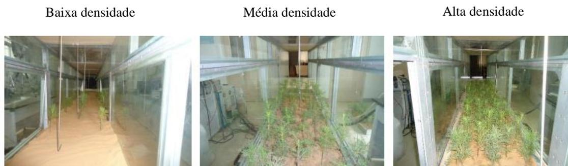
Figura 9: Estudo em túnel de vento com a utilização de plantas naturais, tubo de Pitot posicionados ao longo da linha central e diferentes densidades de cobertura vegetal (Adaptado de Miri, Dragovich e Dong, 2017).
