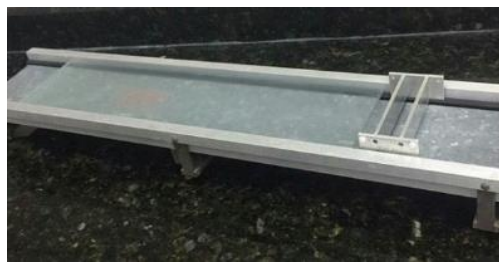
Figura 1. Acessório para espalhamento das blendas e obtenção dos filmes.
