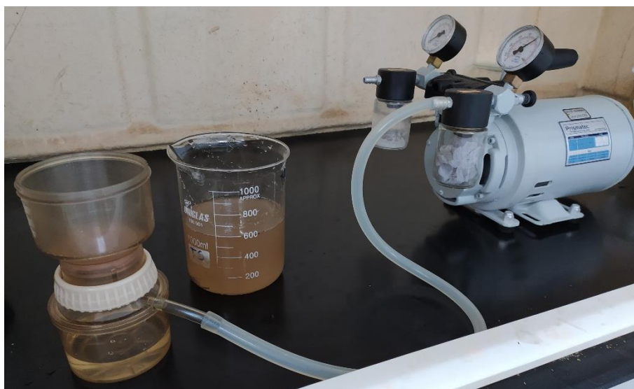
Figura 6 – Filtração da solução hipersalina com auxílio da bomba a vácuo, para coleta de microplásticos.
