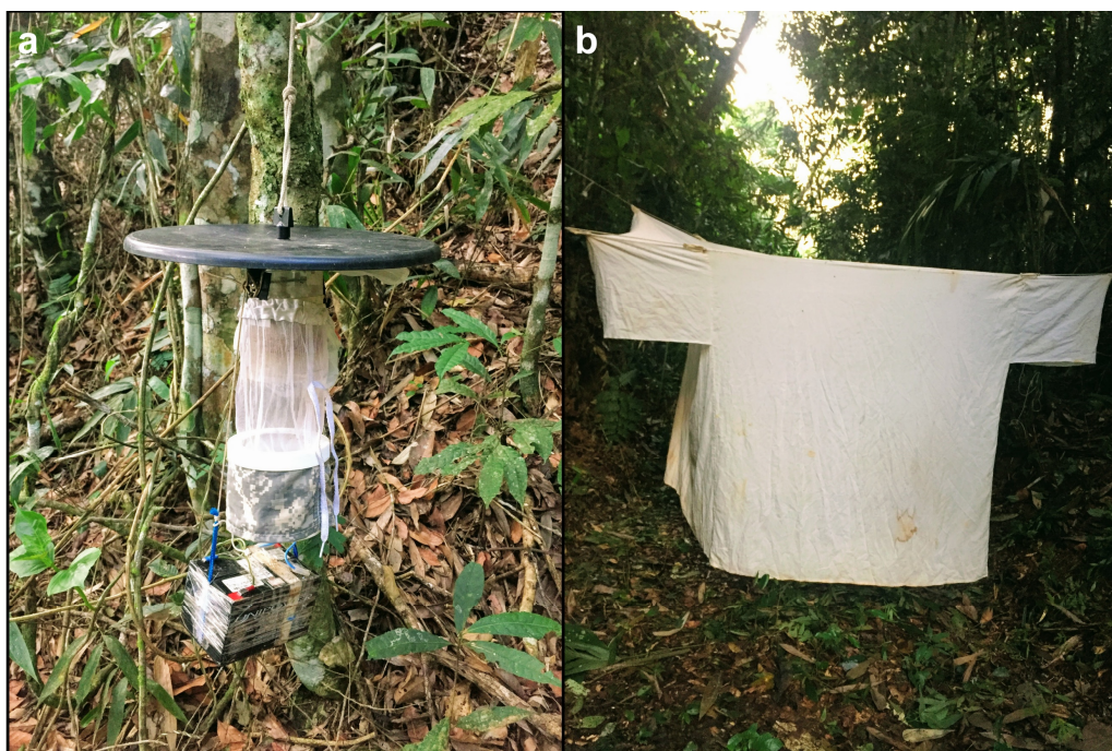
Figura 6 – Armadilhas instaladas no interior da floresta para captura de anofelinos. A- Armadilha luminosa do tipo “CDC” (Center for Disease Control); B- Armadilha de Shannon. Fonte: Arquivo pessoal.
