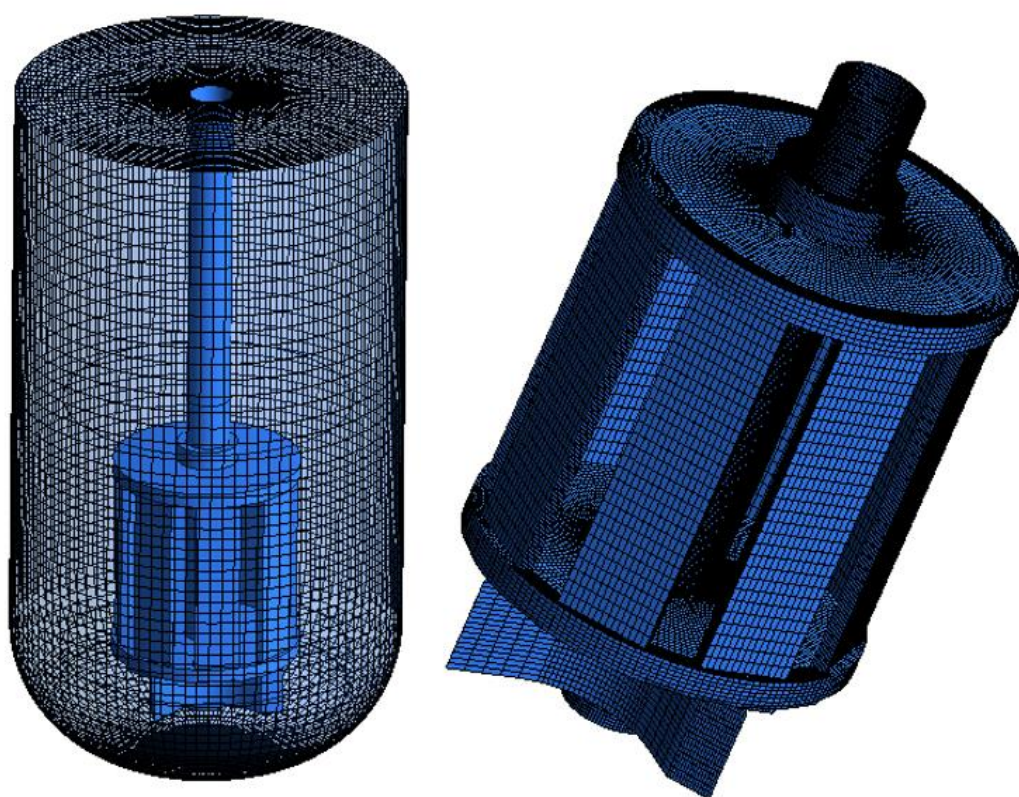
Figura 36: Detalhes da malha superficial do tanque liso (sem janelas + RC+impelidor): a esquerda a malha da parede do tanque; a direita, malha no RC e impelidor
