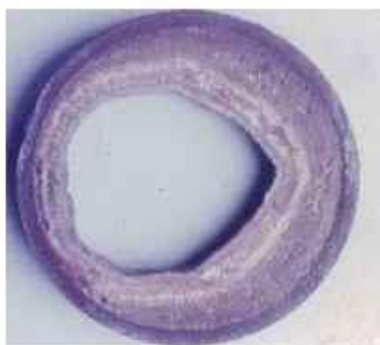
Figura 2: Incrustação inorgânica Carbonato de Cálcio ( CaCO_3 )
