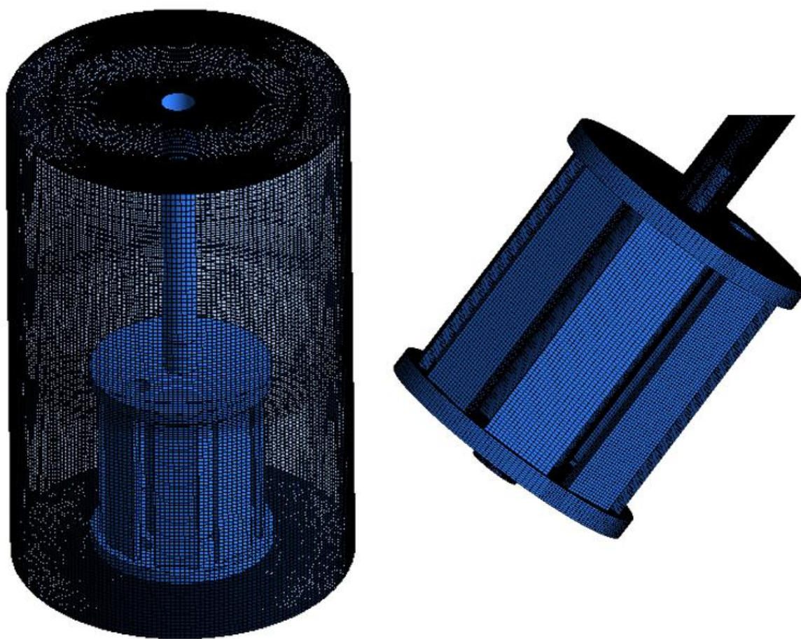
Figura 38: Detalhes da malha superficial do Tanque ASTM: a esquerda a malha da parede do tanque; a direita, malha no RC
