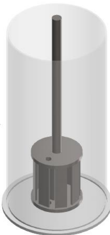
Figura 48: Tanque ASTM G170 para validação.
