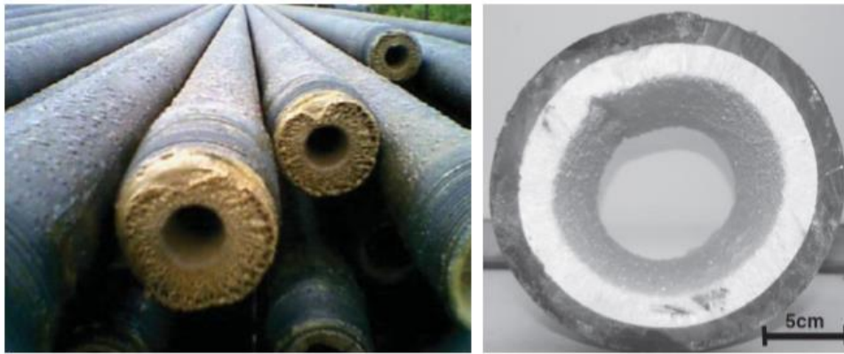
Figura 3: Exemplo de incrustações inorgânicas: Sulfato de bário ( BaSO_4 ) a esquerda e gipsita ( CaSO_4 \cdot H_2O ) Direita. Fonte: (COSMO,2013)
