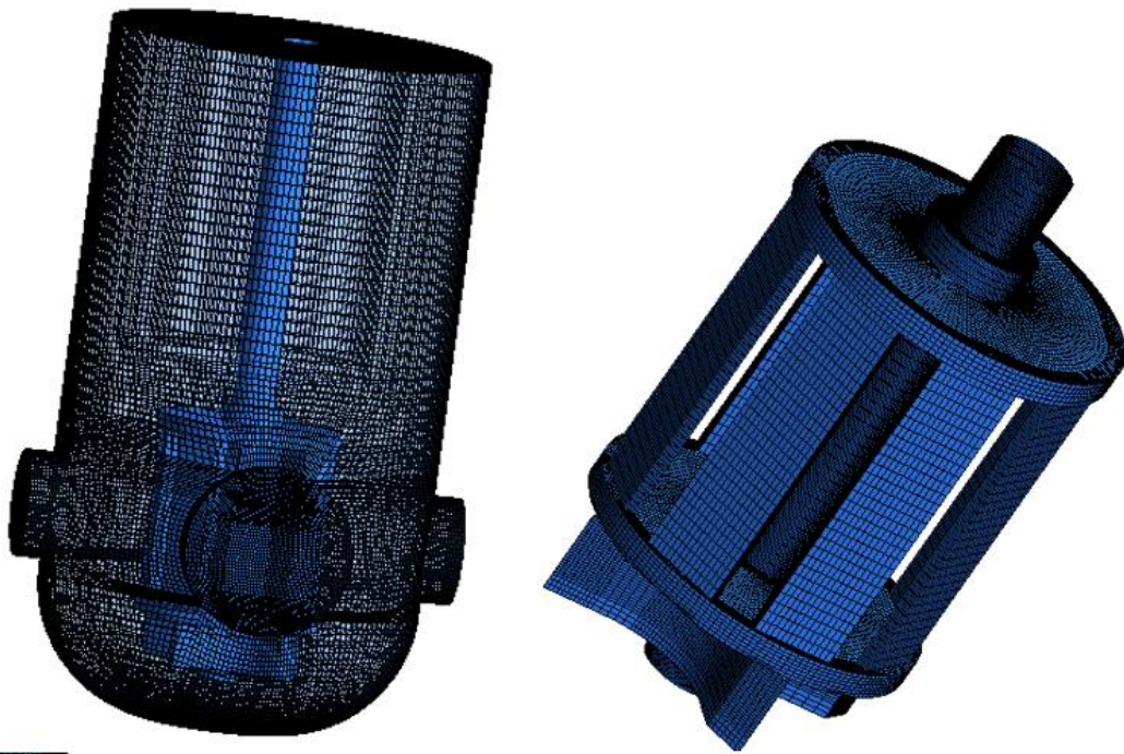
Figura 34: Detalhes da malha superficial do tanque original: a esquerda a malha da parede do tanque; a direita, malha no RC e impelidor
