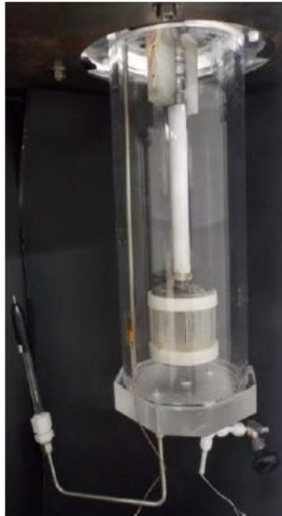
Figura 19: Configuração RC modificada para testes eletroquímicos. Fonte: Vera et al (2017).
