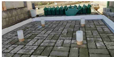
Colocação dos frascos para controlar a uniformidade da precipitação.
