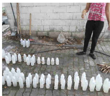
Frascos coletados a cada 30 segundos para medição dos volumes.
