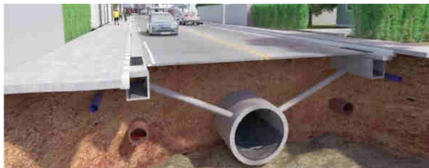
Figura 8 – Sistema clássico de drenagem, composto por elementos como sarjeta, bocas de lobo e galerias.
