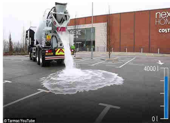
Figura 9 – Concreto asfáltico poroso (CPA):
