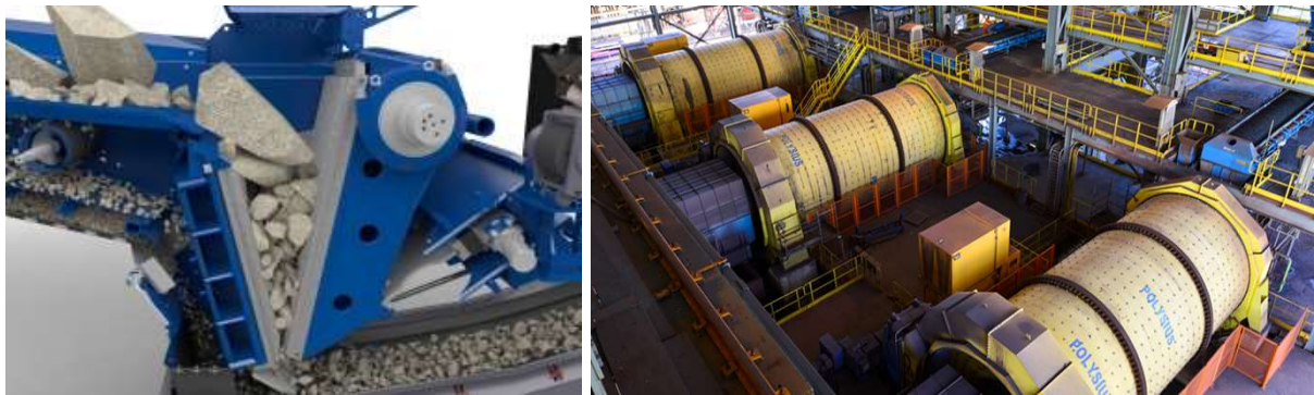
Figura 6 – (a) Britador tipo mandíbula e (b) moinhos de bolas da 8ª planta de pelotização Vale S.A.
