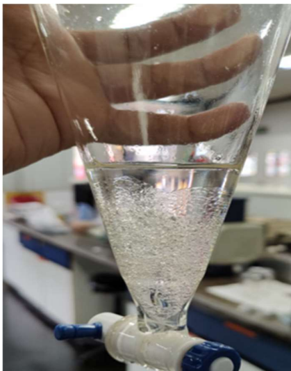
Figura 34 - Emulsão gerada durante extração líquido-líquido
