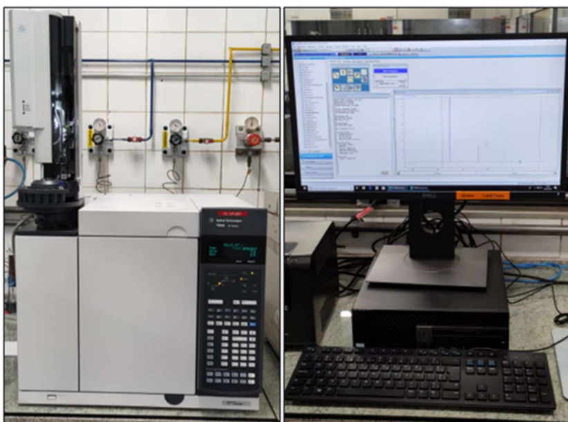
Figura 32 - Cromatógrafo GC-FID marca Agilent utilizado nas análises
