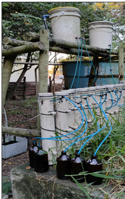
Figura 28 - Coleta de amostras na saída de cada seção de leito fixo
