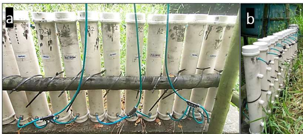
Figura 22 - Entrada de efluente e saída do efluente tratado
