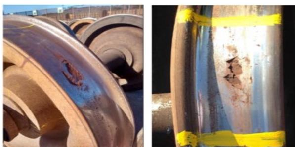
Figura 15 – Rodas com *Spalling*. Fonte: (CARVALHO, 2019), adaptado pelo autor.
