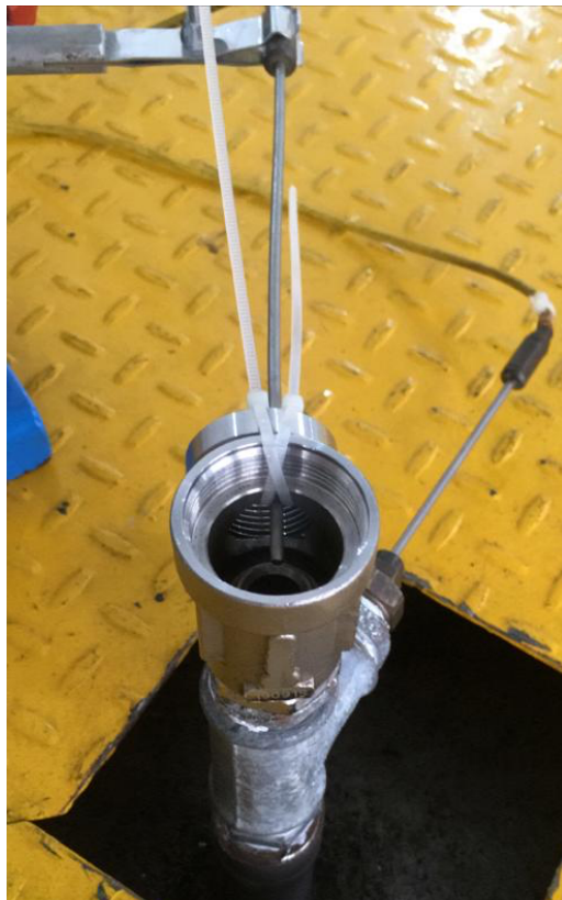
Figura 36. Imagem do bocal com termopares.
