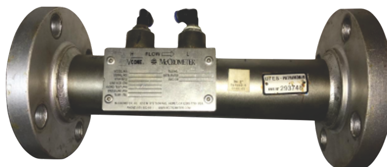
Figura 27. V-Cone da McCrometer \Phi 2" , \beta=0,5 , C_d=0,65 .
