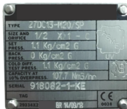
Figura 30. Plaqueta de identificação da válvula de segurança certificada Modelo D, indicando a vazão calibrada, bem com a pressão de abertura.
