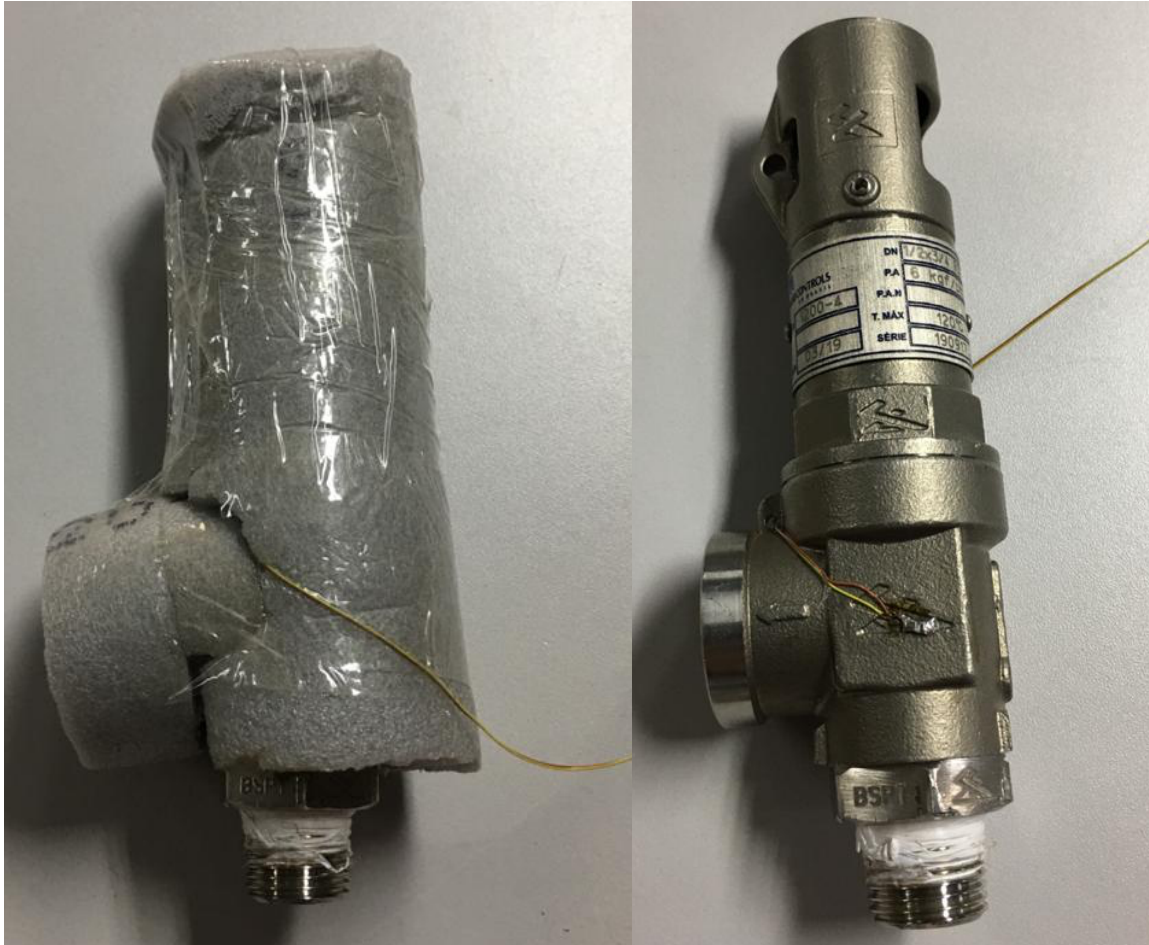
Figura 35 – Válvula de segurança (PSV) com e sem isolamento térmico.
