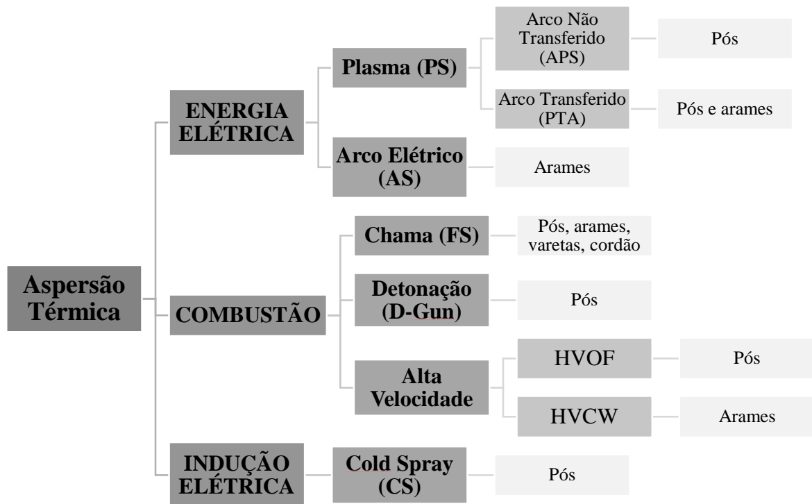
Figura 1 – Fluxograma dos principais processos de aspersão térmica classificados de acordo com suas fontes de energia.
