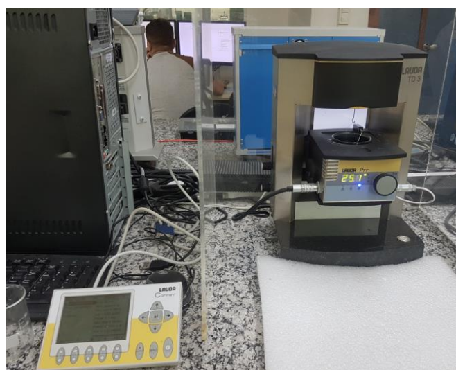
Figura 2.3: Tensiômetro da fabricante LAUDA utilizado para medir a tensão interfacial.
