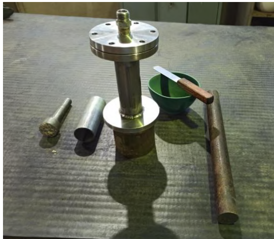
Figura 2.7: Representação da estrutura do meio poroso e itens utilizados para compactação da areia.
