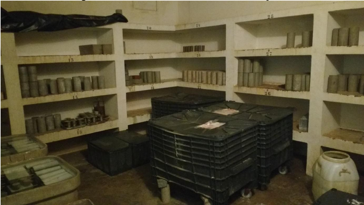
Figura 17 - Câmara úmida antes das alterações
