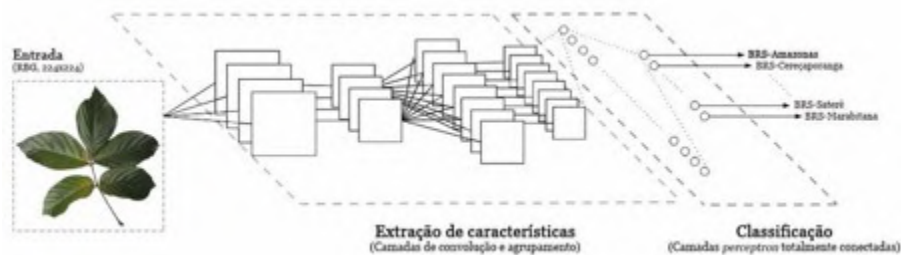
Figura 7: Exemplo de uma rede neural convolucional ilustrando o processo de classificação de cultivares de guaraná. Fonte: [SS17]
