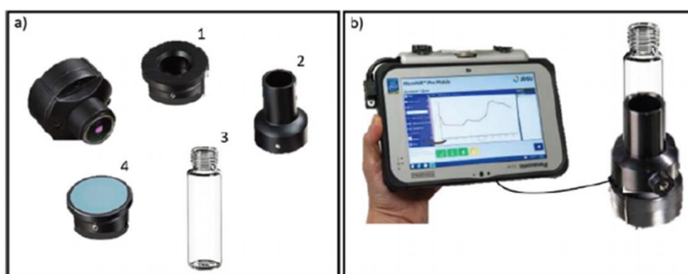
Figura 20. (a) Acessórios do equipamento MicroNIR: (1) collar ; (2) suporte do vial; (3) vial de 5 mL; e (4) windowed collar . A imagem do instrumento microNIR conectado a um tablet é mostrada na Figura 1b (adaptado de CORREIA, TOSATO, DOMINGOS et al. , 2018).
