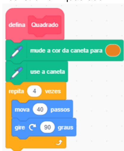
Figura 43 – Sequência lógica para construir um quadrado.
