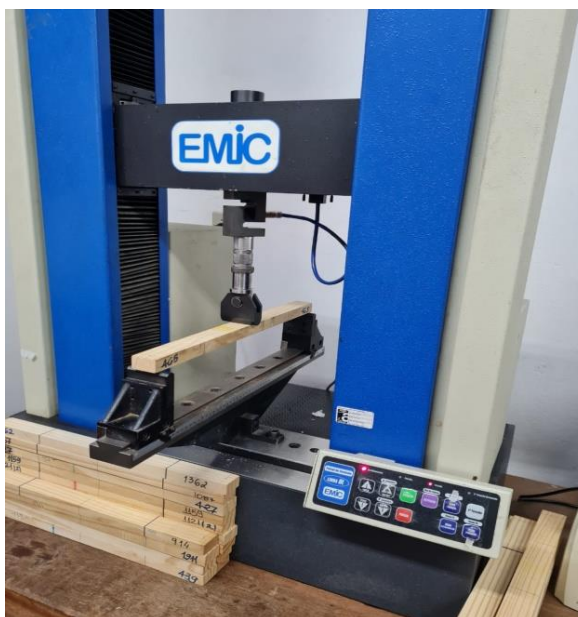
Figura 6 – Ensaio de flexão estática na máquina de ensaios universal (EMIC) para obtenção do módulo de elasticidade estático.
