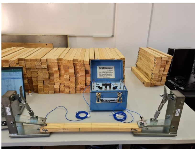
Figura 5 – Ensaio de ondas de tensão com o instrumento de stress wave timer Metriguard para obtenção do módulo de elasticidade dinâmico.
