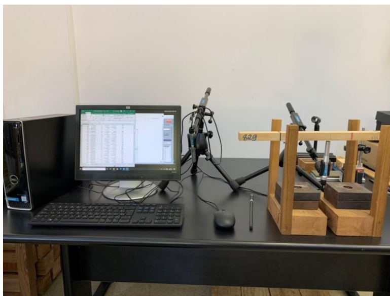
Figura 2 – Ensaio de vibração transversal livre com o software Sonelastic® para obtenção do módulo de elasticidade dinâmico na vibração transversal livre.
