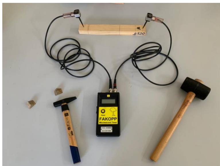
Figura 4 – Ensaio de ondas de tensão com o instrumento de stress wave timer Fakopp, para obtenção do módulo de elasticidade dinâmico.
