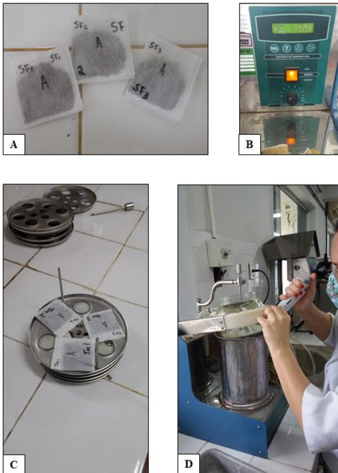
Prancha 3. Procedimento para obtenção de Fibra em Detergente Neutro (FDN) das pupas de Spodoptera frugiperda (Lepidoptera: Noctuidae). A) amostras secas e maceradas em saquinhos de TNT antes da análise; B) digestor onde as amostras foram mantidas em ebulição por cinco minutos; C) metodologia de montagem das amostras para serem levadas ao digestor; D) digestor onde as amostras foram mantidas em refluxo por 60 min.
