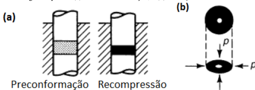
Figura 13 – Prensagem a quente: (a) modo de deformação; e (b) condições de tensão.
