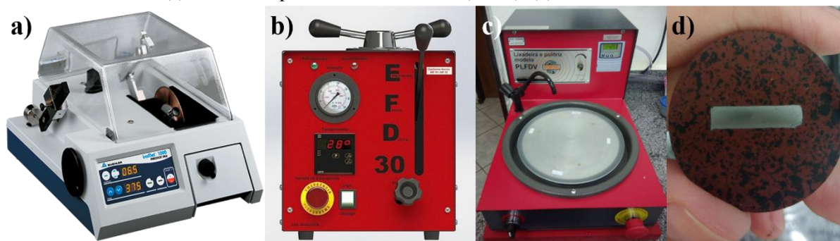
Figura 34 – (a) Cortadora metalográfica IsoMet 1000 (Buehler); (b) Embutidora Metalográfica EFD30 (Fortel); (c) Lixadeira e politriz modelo PLFDV (Fortel); (d) Amostra lixada.
