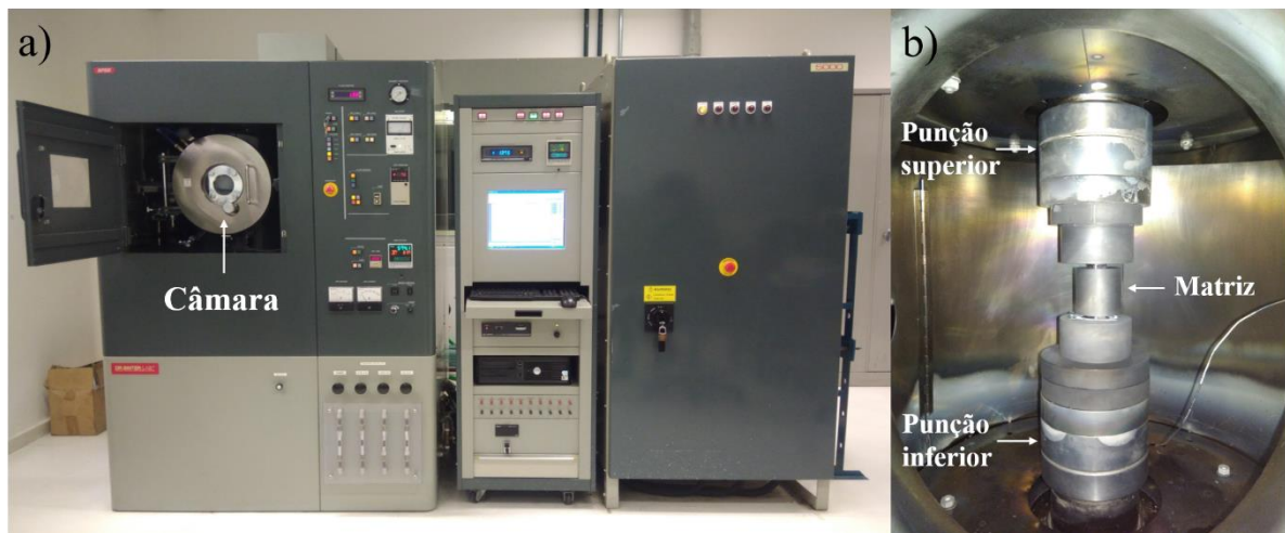
Figura 33 – (a) Máquina de Spark Plasma Sintering modelo 1050 (SPS Syntex Inc.); (b) Montagem da matriz com a amostra na SPS.
