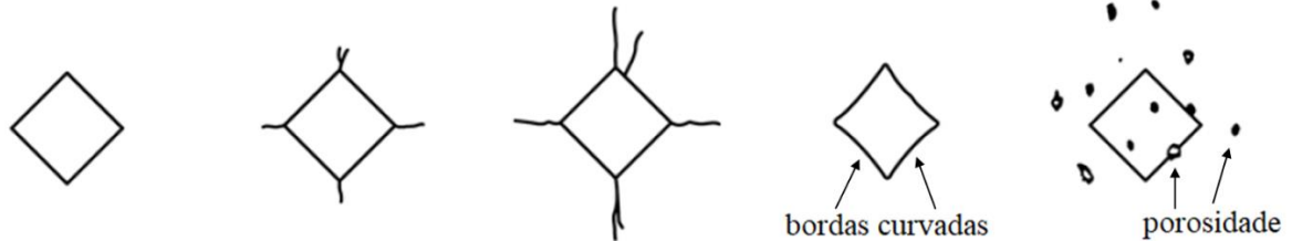
Figura 38 – Indentações aceitáveis segundo a norma ASTM C1327 – 15.
