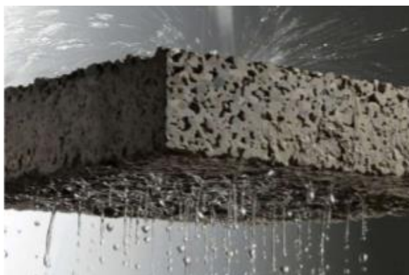
Figura 6: Demonstração da permeabilidade do pavimento de concreto poroso
