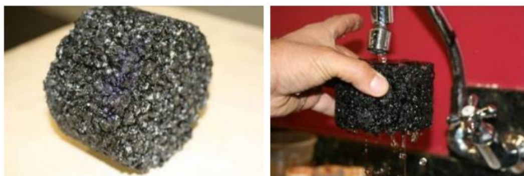
Figura 7: Demonstração da permeabilidade do pavimento de asfalto poroso
