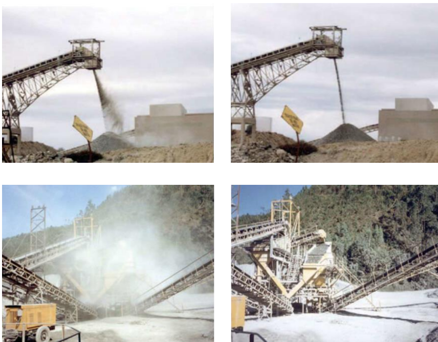
Figura 17. Aplicação dos surfactantes Nalco para supressão de pó em indústrias do setor de mineração. Fonte: Adaptado de NALCO (2010) 27
