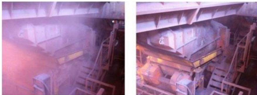
Figura 18. Região de descarga do Alimentador Vibratório. (a) sem uso de supressão de pó, (b) com supressão de pó. Fonte: SARTIM et al. (2015) 32
