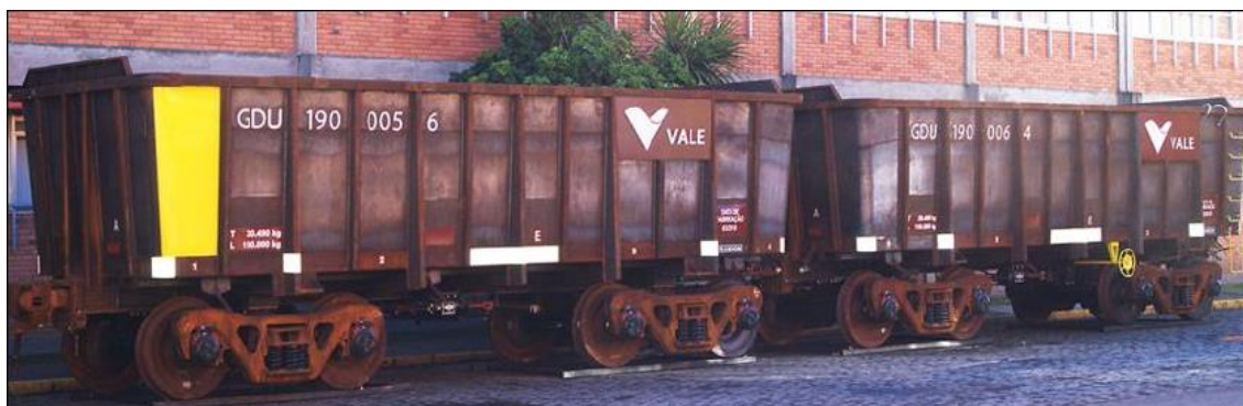
Figura 10. Vagões do tipo gôndola. Fonte: TRENTIN (2015) 15
