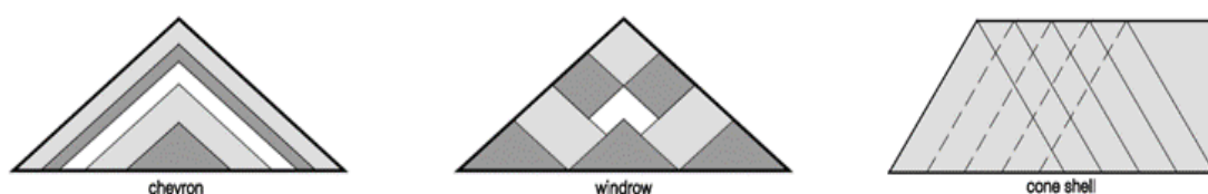
Figura 9. Diagrama dos tipos de empilhamento de minério. Fonte: Adaptado de SLOSS (2014) 12 .
