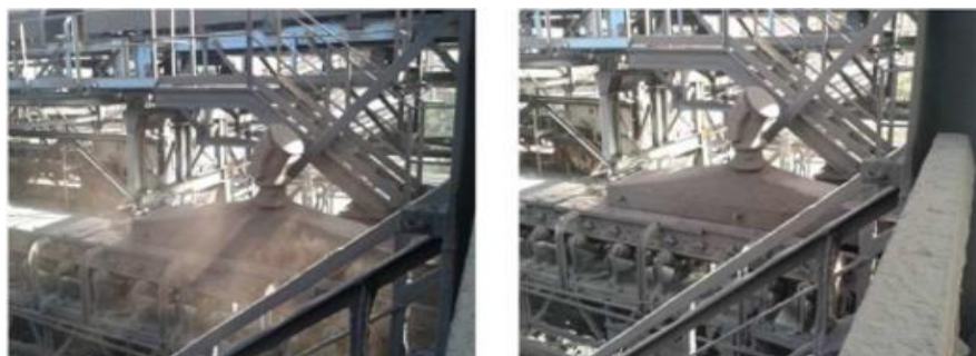
Figura 20. Região de transferência de correia transportadora. (a) sem uso de supressão de pó, (b) com supressão de pó. Fonte: SARTIM et al. (2015) 32
