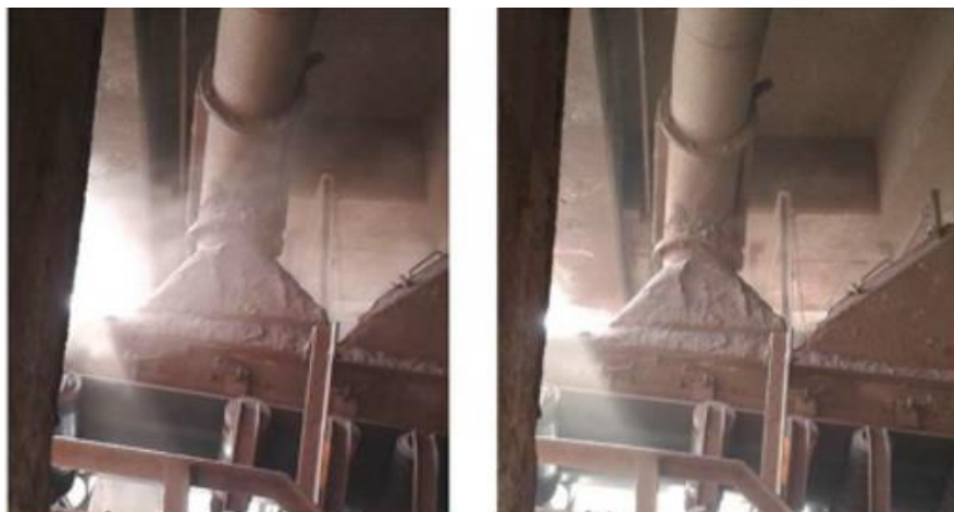
Figura 19. Região de transferência de correia transportadora (a) sem uso de supressão de pó, (b) com supressão de pó. Fonte: SARTIM et al. (2015) 32
