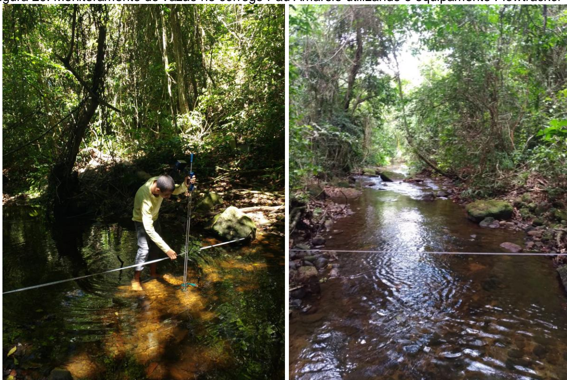
Figura 20: Monitoramento de vazão no córrego Pau Amarelo utilizando o equipamento Flowtracker
