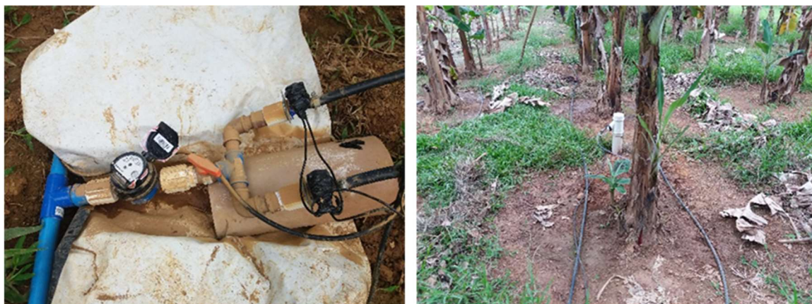
Figura 2: Detalhes do sistema de irrigação por gotejamento com acionamento automático.
