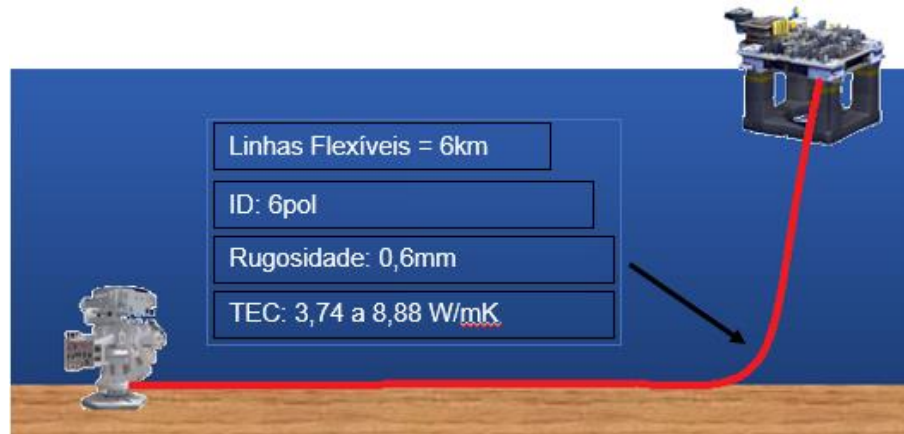
Figura 28 – Esquema simplificado dos equipamentos submarinos (Dados conforme Tabela 4)
