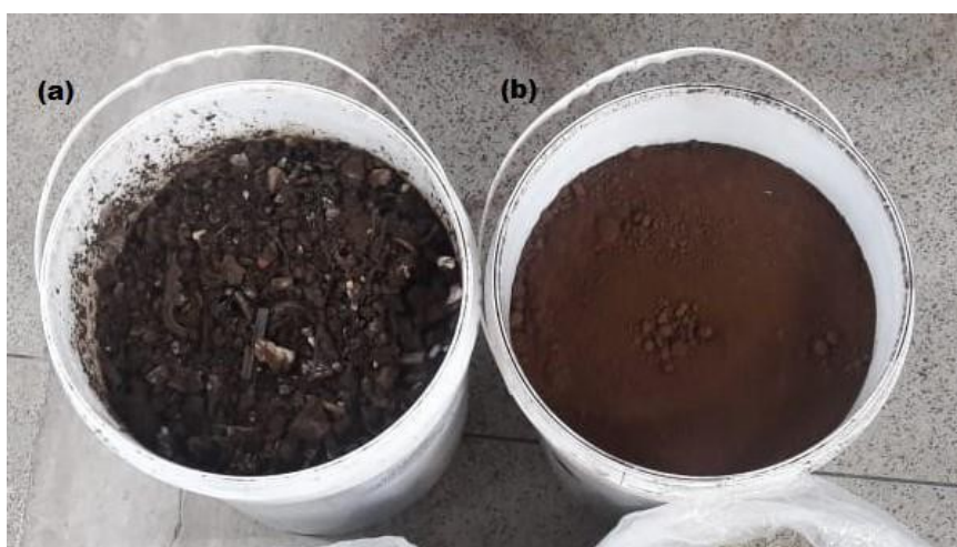
Figura 15 - Terra de Shredder (a) e Pó de FEA (b)
