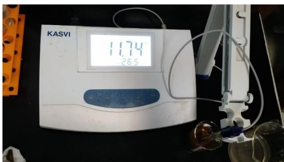
Figura 22 – pHmetro utilizado na identificação do pH dos resíduos
