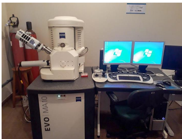
Figura 24 – Equipamento utilizado no ensaio de microscopia eletrônica de varredura
