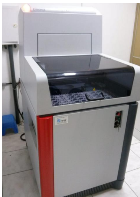
Figura 23 – Difratômetro utilizado no ensaio de caracterização mineralógica dos resíduos
