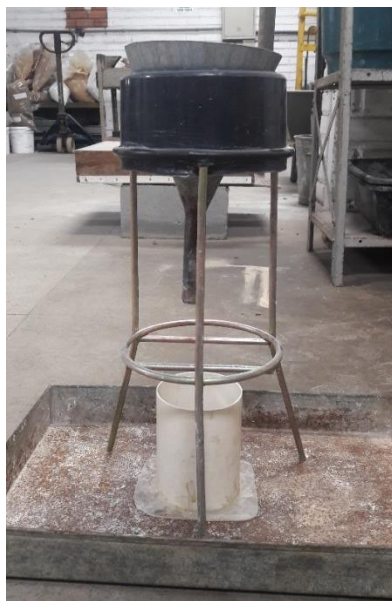
Figura 20 – Ensaio de massa unitária realizado nos resíduos siderúrgicos
