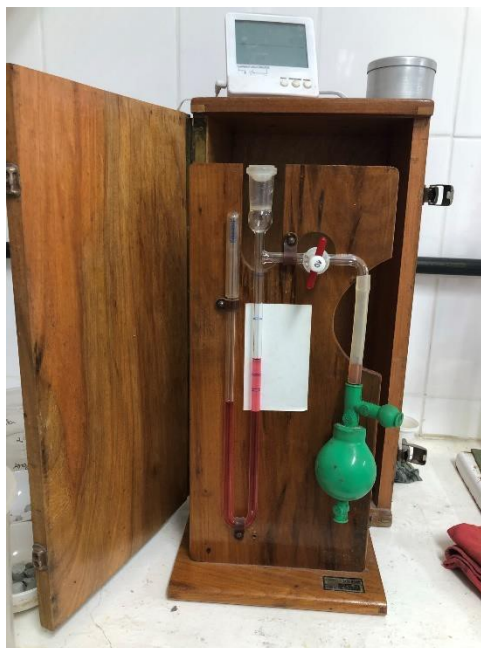
Figura 21 – Ensaio de determinação da superfície específica Blaine
