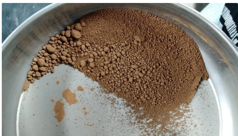
Figura 16 – Aglomeração do resíduo pó de FEA durante peneiramento na peneira de 75 \mu\text{m}
