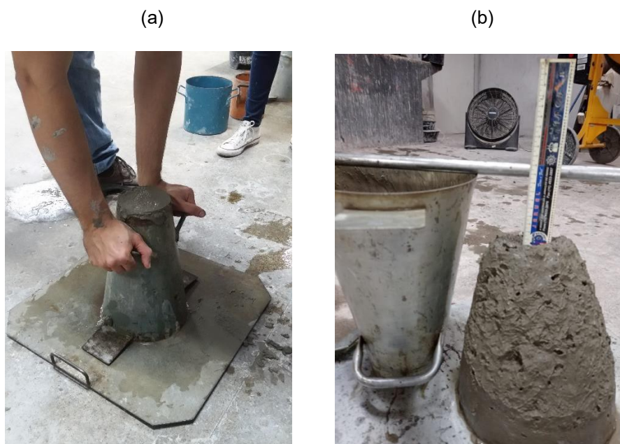
Figura 28 – Ensaio de abatimento de tronco de cone
