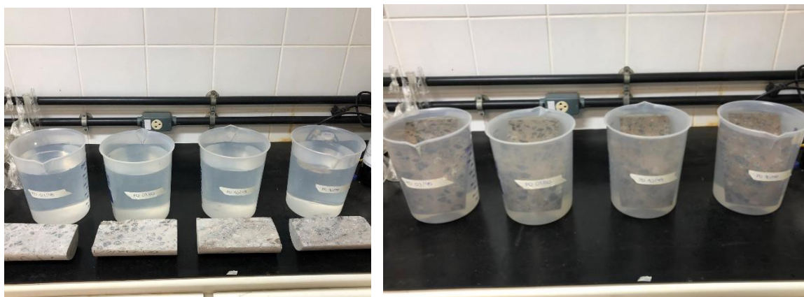
Figura 37 – Ensaio de lixiviação de contaminantes nas amostras de concreto
