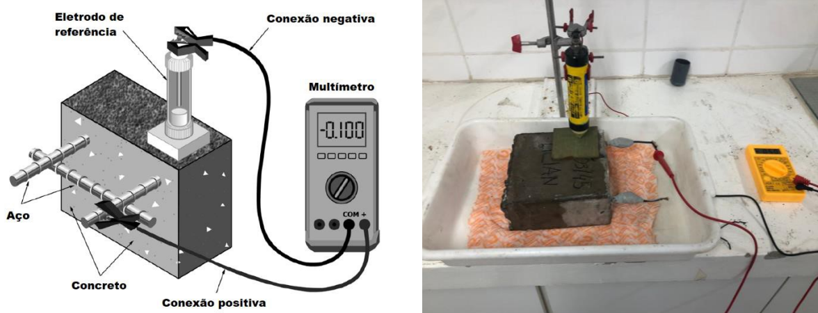
Figura 34 - Esquema ilustrativo do ensaio de potencial de corrosão (a) e corpo de prova submetido ao ensaio (b)
