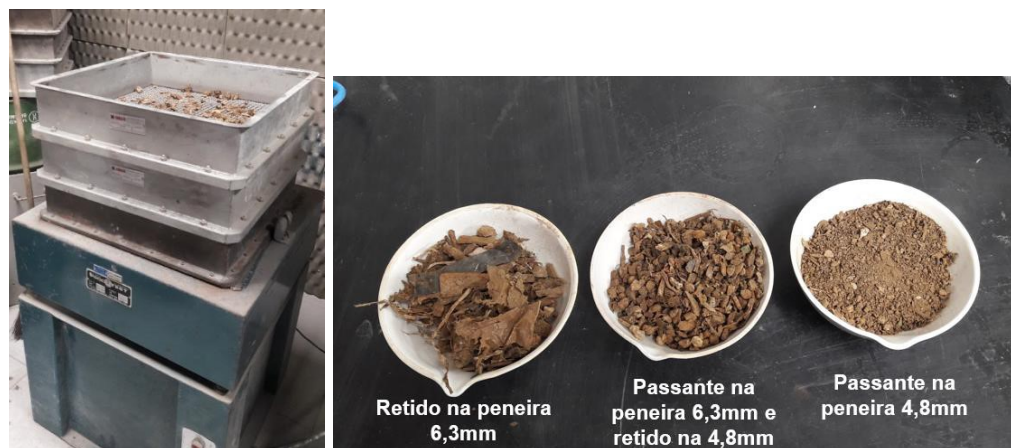
Figura 18 - Peneiramento da Terra de Shredder e granulometria passante e retida em cada peneira
