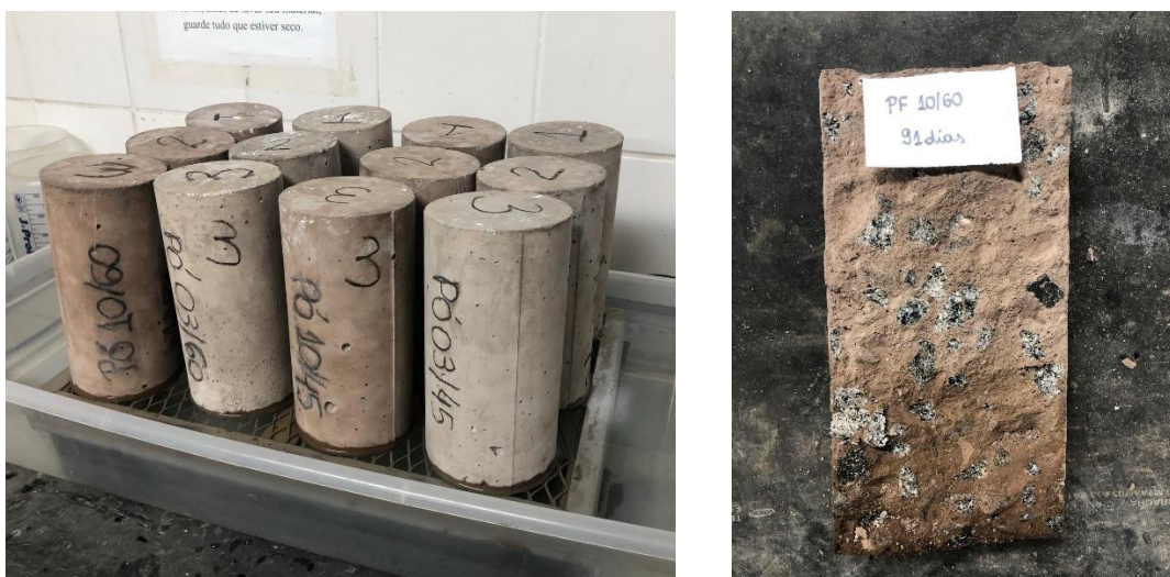
Figura 32 – Corpos de prova em contato com película de água a 5 \pm 1 mm (a) e corpos de prova rompidos após o fim do ensaio (b)
