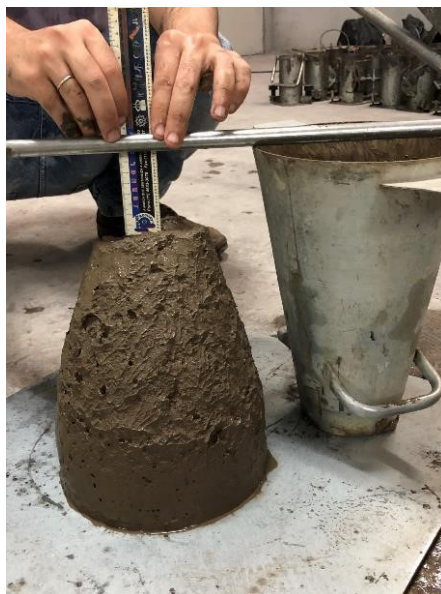
Figura 31 – Avaliação do índice de consistência através da determinação do abatimento do tronco de cone do concreto
