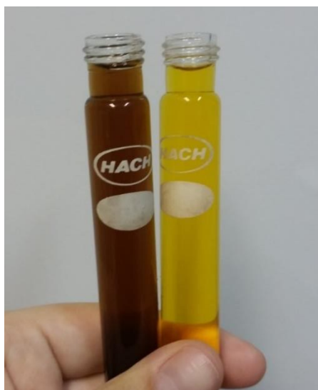
Figura 26 – Avaliação do teor de matéria orgânica do agregado miúdo
