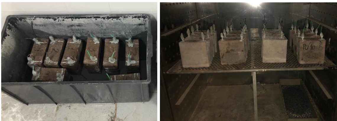
Figura 33 – Ciclos de imersão e secagem dos corpos de prova do ensaio de corrosão
