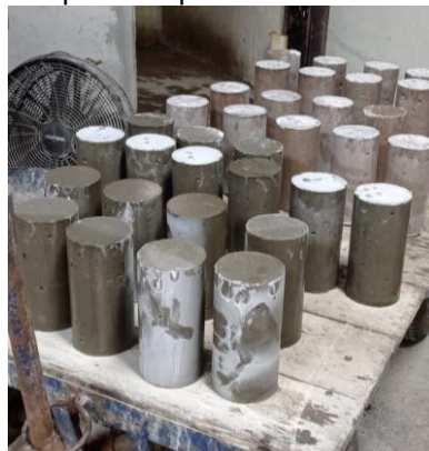
Figura 19 - Corpos-de-prova depois de moldados e retirados da cura
