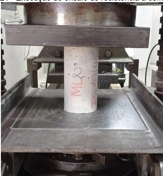
Figura 21 - Execução do ensaio de resistência à compressão
