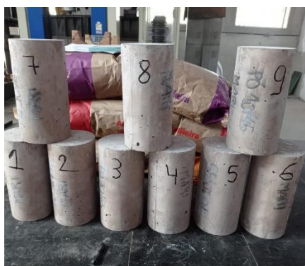
Figura 19 - Corpos-de-prova depois de moldados e retirados da cura
