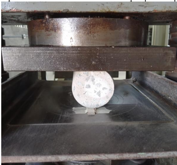
Figura 22 - Execução do ensaio de resistência à tração por compressão diametral
