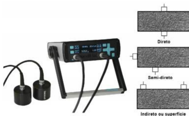
Figura 23 - Equipamento utilizado para obtenção da velocidade de propagação ultrassônica e posição dos transdutores.
