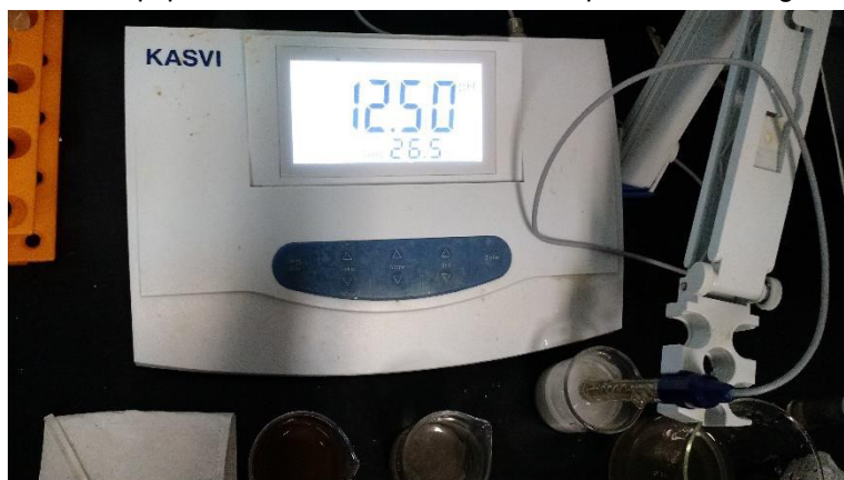
Figura 17 - Equipamento utilizado no ensaio de potencial hidrogeniônico
