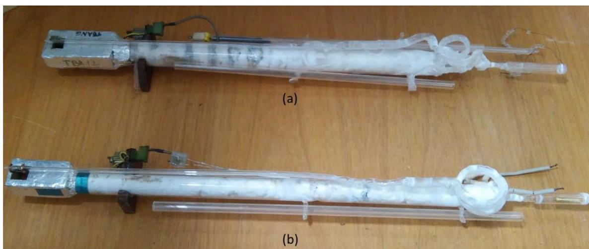
Figura 4.8 - Diferentes aparelhos TBDTA: (a) pressão máxima de 32 bar; (b) pressão máxima de 18 bar.
