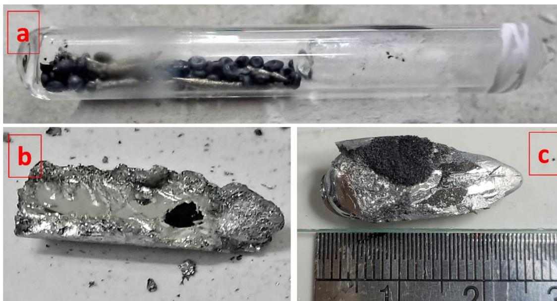
Figura 5.15 - Amostras produzidas pelo método de encapsulamento comum com variações nos fatores de preenchimento. (a) Amostra de referência BISE20, enquanto em reagentes na ampola de reação, com redutor de volume à direita e (b) após ser retirada da ampola. (c) Amostra de referência BISE28.
