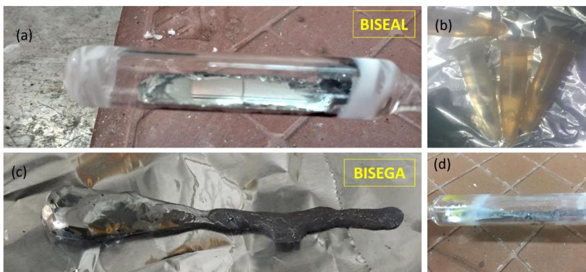
Figura 5.23 - Amostras de  $\text{Bi}_2\text{Se}_3$  produzidas a partir de dopagem por substituição. (a) Amostra com dopagem de alumínio (BISEAL) ainda na ampola reação e (b) após o seccionamento com destaque para o dióxido de selênio em fase coloidal (vermelho) depositado nas paredes do tubo de armazenamento (Empendorf®). (c) Amostra com dopagem de Gálio (BISEGA) após e (d) antes da retirada da ampola de reação.
