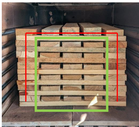
Figura 6 – Empilhamento para o processo em sistema aberto. Destaque em verde para as peças de interesse (teca) e em vermelho as peças utilizadas para proteção (pinus).
