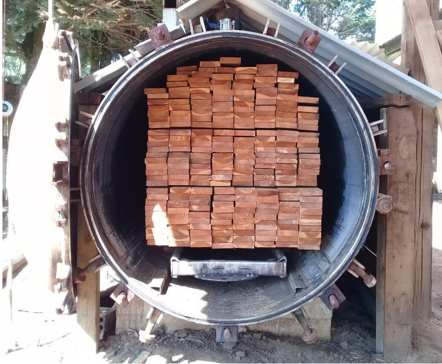
Figura 4 – Autoclave de propriedade da empresa carregada com o material.
