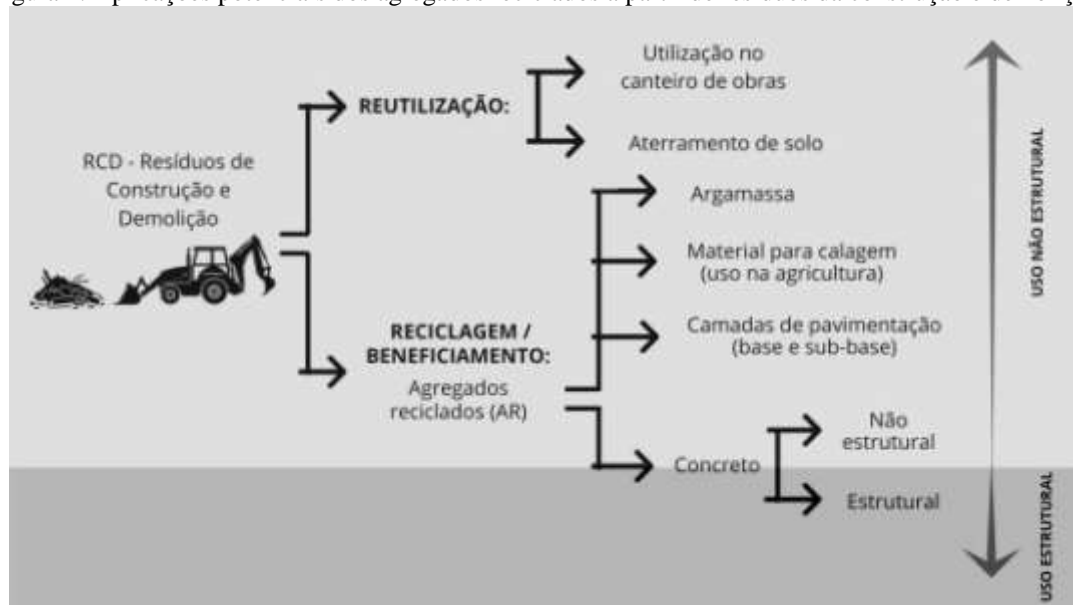
Figura 2: Aplicações potenciais dos agregados reciclados a partir de resíduos da construção e demolição.
