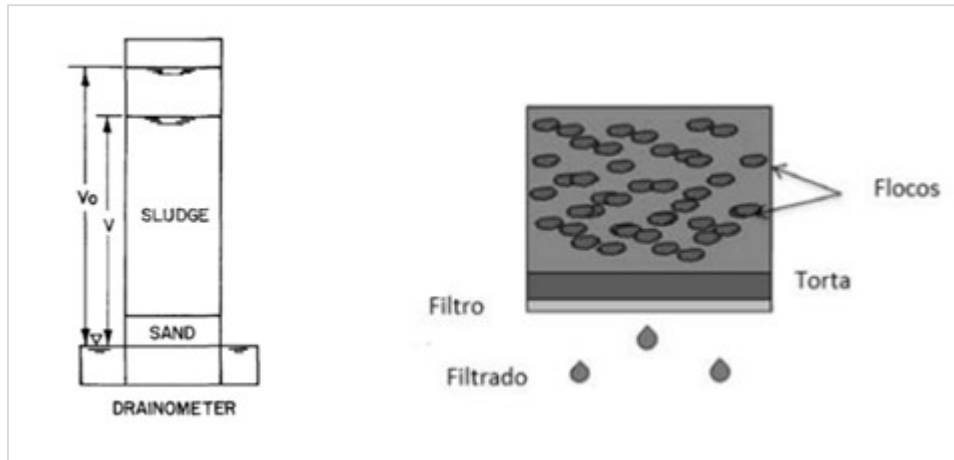
Figura 6 – Drenômetro utilizado para os experimentos de desaguamento e a formação da torta filtrante.
