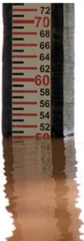
Figura 62 - Régua com registro do nível da água do rio Doce, que chegou a 3,50 m.
