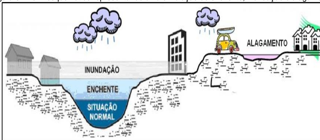
Figura 6 - Perfil esquemático representando uma simulação de enchente, inundação e alagamento.
