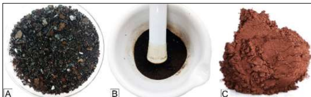
Figura 2. A – Material seco em estufa após raspagem. B – Processo de trituração do extrato. C – Extrato tânico em pó.
