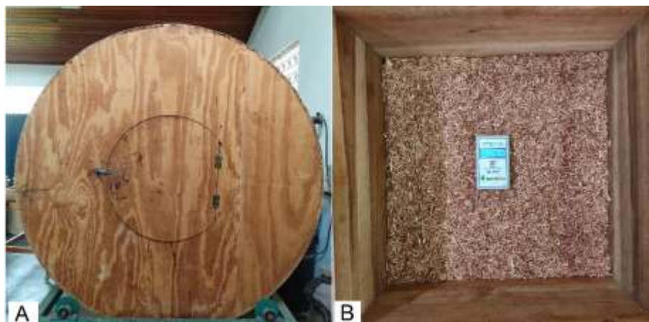
Figura 2. Processo de aplicação dos adesivos e formação do colchão de partículas
