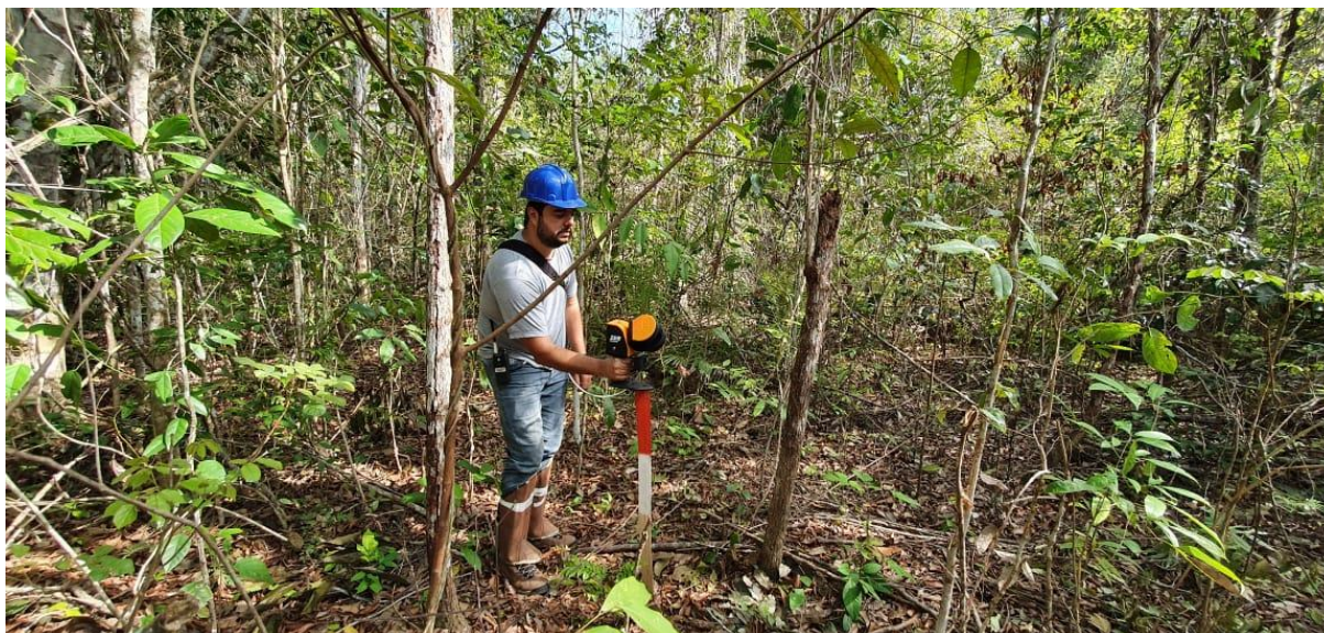
Figura 11 – Coleta de ponto de controle com o LiDAR PLS no vértice da parcela.
