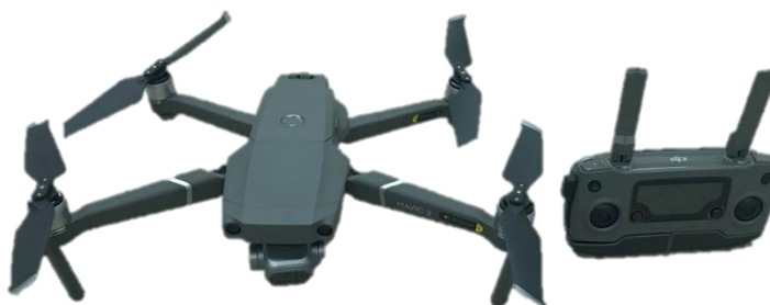
Figura 7 – RPA DJI Mavic 2 PRO, utilizado para os levantamentos aerofotogramétricos.
