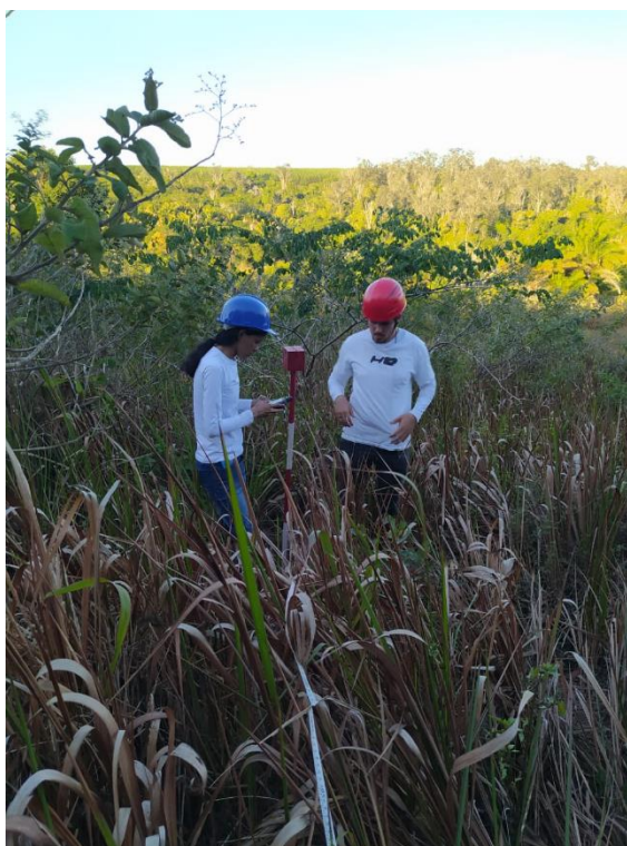
Figura 4 – Demarcação de vértices de uma parcela com o auxílio de bússola e esquadro.
