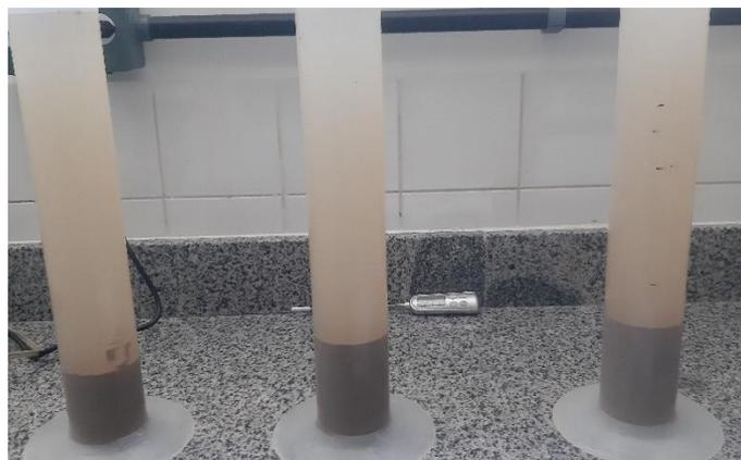
Figura 3: Testes de consolidação realizados no Laboratório de sedimentologia.
