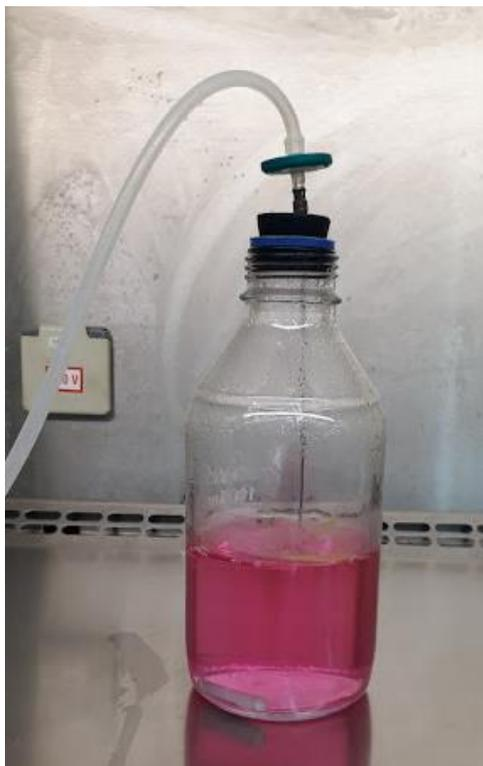
Figura 8: Meio Postgate C sendo purgado com nitrogênio.
