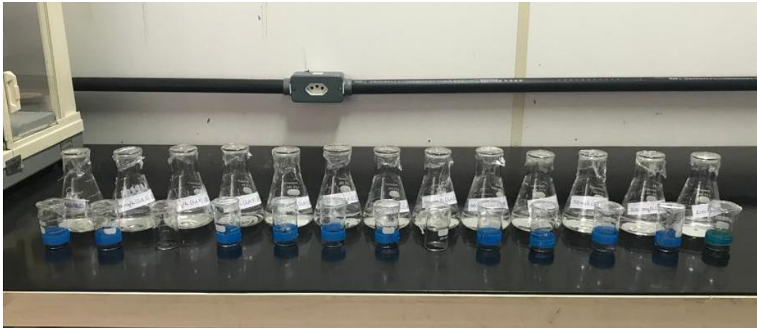
Figura 6 - Frascos Erlenmeyer com as concentrações de 2,4-D analisadas (0 a 200 \text{mg.L}^{-1} ) e beckers contendo 20 mg de adsorbente
