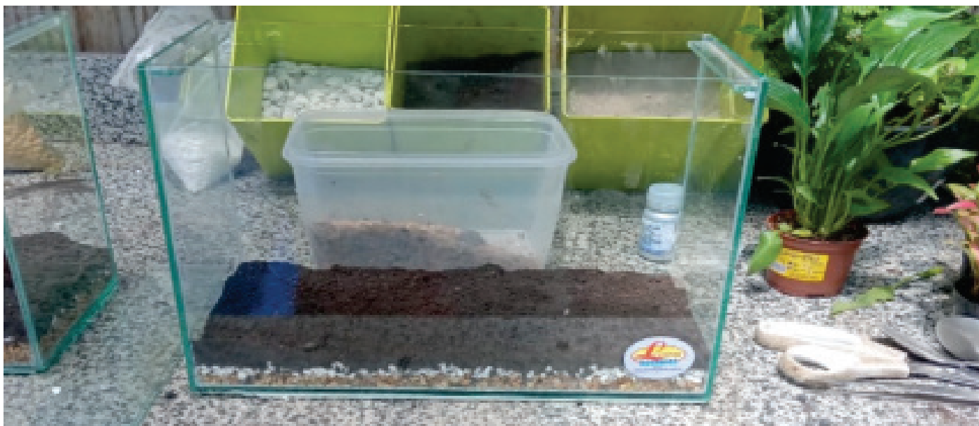
Figura 3 – Carvão e terra vegetal utilizados para filtração da água
