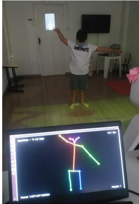
Figura 27. Demonstração do funcionamento do *software* OpenPose durante o jogo “Arara Vermelha” com imagem captada pela câmera acoplada ao robô MARIA T21. Fonte: Dados da Pesquisa.
