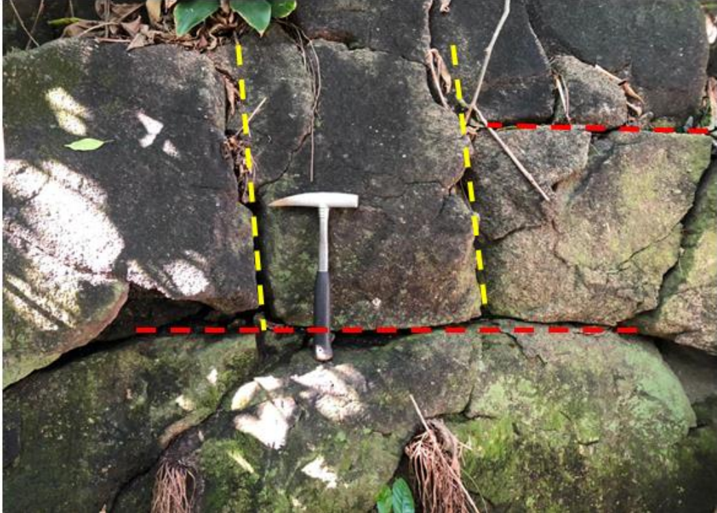
Figura 42 – Bloco com fraturas de orientação NNW-SE (vermelho) e ENE-WSW (amarelo).
