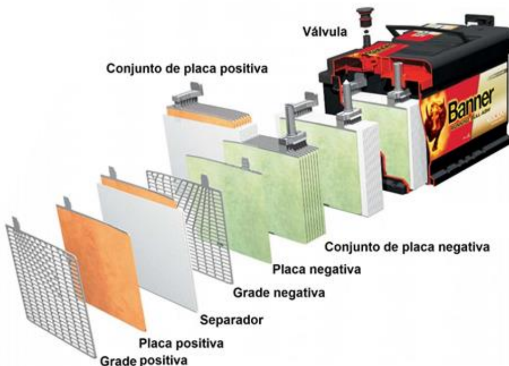
Figura 1. Visão expandida esquemática de uma bateria chumbo-ácido.
